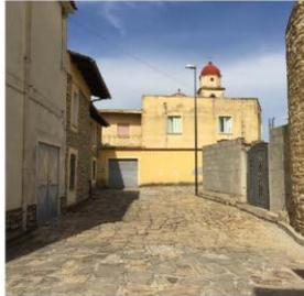
Esempio di pavimentazione in lastronato di arenaria, via Chiesa
